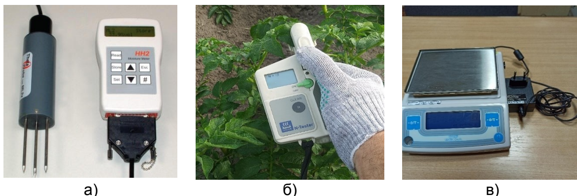
Рисунок 2 – Используемые приборы: а) влагомер почвы HH2 Delta-T Devices; б) N-тестер для листовой диагностики растений; в) электронные весы BM 313
