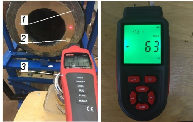
Рисунок 4 – Измерение скорости вращения барабана и силы вакуума: 1 – барабан сепаратора; 2 – отражающая поверхность; 3 - цифровой тахометр UNI-T UT372
