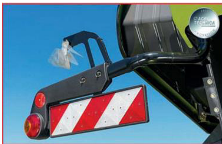
Рисунок 6 – Датчик бокового ветра и поперечного уклона комбайна “Lexion”
