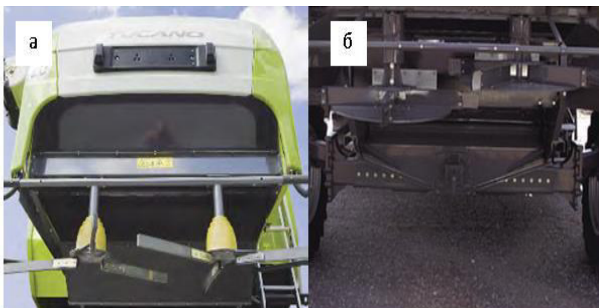
Рисунок 7 – Роторы-разбрасыватели неизмельченной соломы: лопастной комбайна Claas “Tucano” (а); дисковый комбайна Challenger 670В (б)
